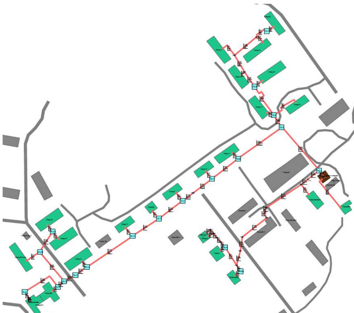
Рис. 24 Схема тепловых сетей с зонами ненормативной надежности от котельной п. Отрадный.
